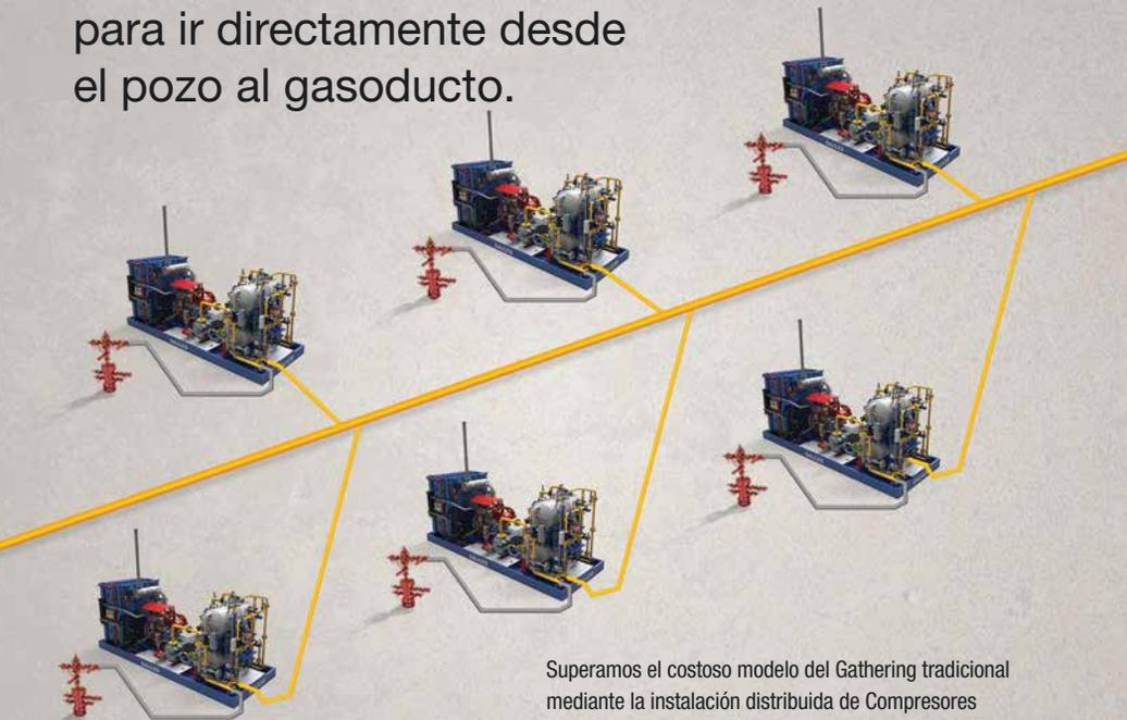
Superamos el costoso modelo del Gathering tradicional mediante la instalación distribuida de Compresores Wellhead de alta presión de descarga. Este cambio de paradigma independiza las condiciones operativas de los pozos, manteniendo la presión de cada cabeza de pozo en su valor óptimo y aportando caudales a la presión requerida por la red que conduce a los gasoductos troncales.
